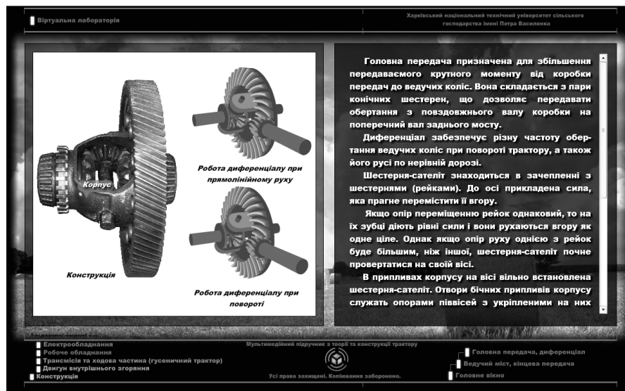
Рисунок 5 – Вікно підрозділу «Головна передача, диференціал» з анімацією роботи диференціалу при прямолінійному русі та повороті трактора
